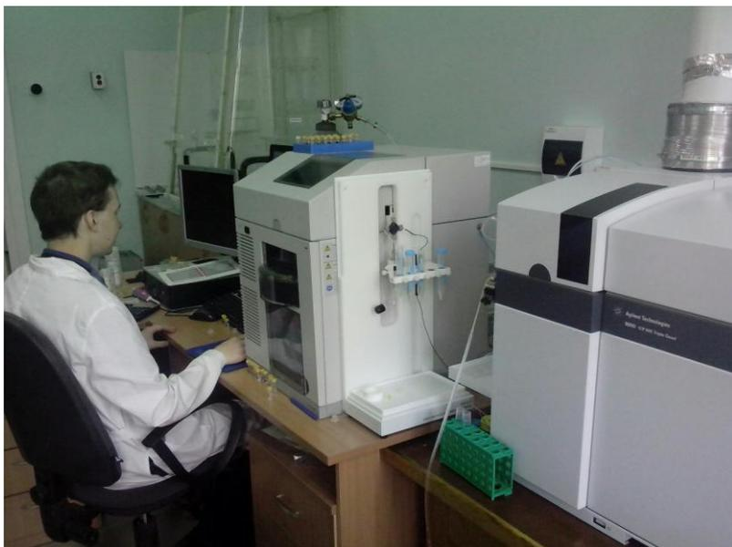
Гибридная система «капиллярный электрофорез (КЭ) - ИСП-МС» - мощный инструмент для изучения вещественного состава объектов, содержащих микроэлементы
