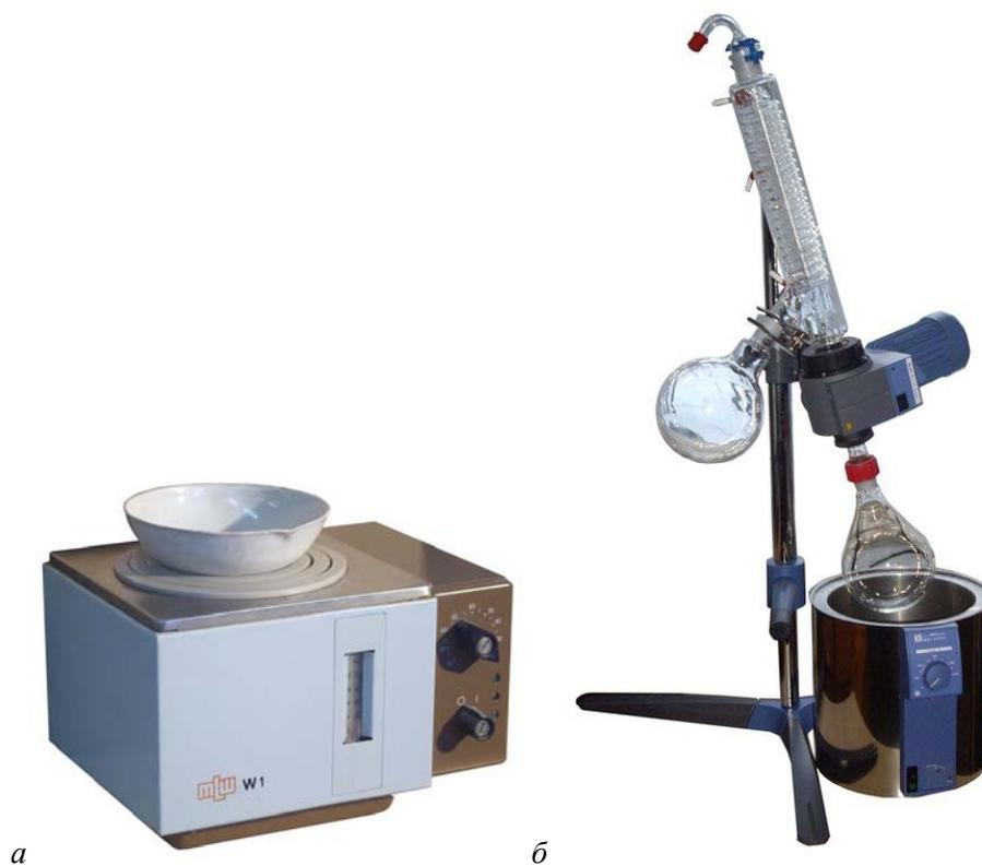
Рис. 14. Приборы для упаривания растворов:
