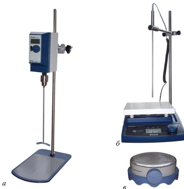
Рис. 11. Лабораторные мешалки: *а* – механическая; *б, в* – магнитные
