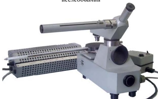
Рис. 16. Столик «Бозциус» – прибор для измерения температуры плавления
