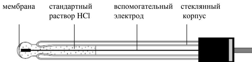
Рис. 6.4. Устройство стеклянного электрода
