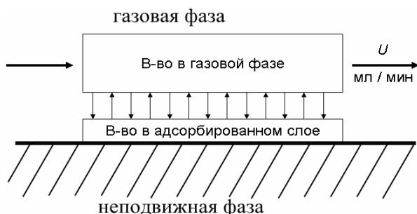
Рис. 7.6. Вещество в газовой фазе и вещество в адсорбированном слое находятся в равновесии и передвигаются по колонке как единая зона или фракция.  $u$  – объёмная скорость газа-носителя
