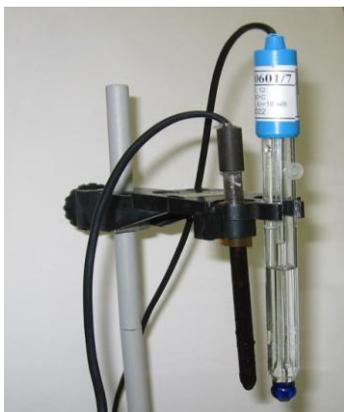
Рис. 6.11. Комбинированный электрод и датчик температуры
