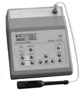
Рис. 5.3. Внешний вид кондуктометра «Анион 4120»
