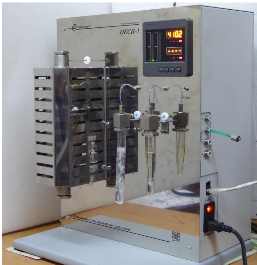
Рис. 7. Вид установки с лицевой стороны. Слева под защитным кожухом находится проточный реактор. Виден регулятор температуры, ниже его расположены две водяные ловушки, которые стоят на выходе газовых потоков
